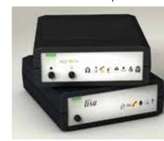
»Gateway« zu mobilen Netzen
